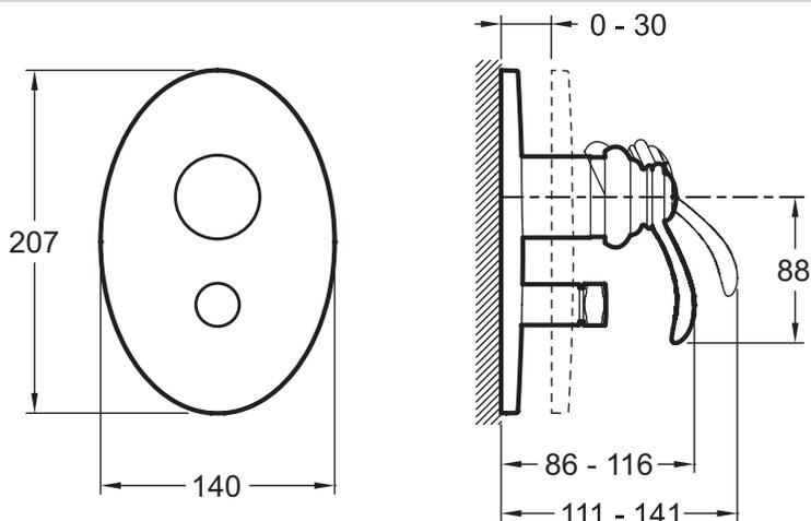
Спецификация продукта : Встраиваемый смеситель с переключателем на 2 выхода. E98722. Коллекция : FAIRFAX. ВЕС : 2.6 кг. МАТЕРИАЛ : N/A. ТИП УСТАНОВКИ : Встраиваемые. TYPE D'ACCESSOIRE : 0. AVEC OU SANS ROBINETTERIE : 0. MITIGEUR : 0. TYPOLOGIE DE ROBINETTERIE DE DOUCHE : 0. FORME DE LA DOUCHE DE TÊTE : 0. INVERSEUR : Встраиваемый. TYPE DE FLEXIBLE : 0. Автоматический переключатель с функцией блокировки.
