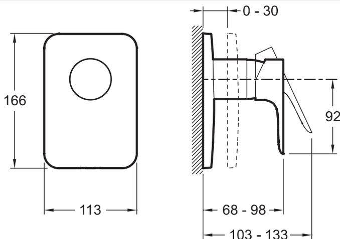
Спецификация продукта : Встраиваемый смеситель. E98705. Коллекция : ALEO. РАЗМЕРЫ (CM) : 24.50 x 16.50 x 11.50 см. ВЕС : 2 кг. МАТЕРИАЛ : N/A. ТИП УСТАНОВКИ : Встраиваемые. TYPE D'ACCESSOIRE : 0. AVEC OU SANS ROBINETTERIE : 0. MITIGEUR : 0. TYPOLOGIE DE ROBINETTERIE DE DOUCHE : 0. FORME DE LA DOUCHE DE TÊTE : 0. INVERSEUR : 0. TYPE DE FLEXIBLE : 0. Комплектующие: встраиваемый смеситель, заглушки и ручка. Подключение: Подключение к выпускному отверстию (например: верхний душ, ручной душ).
