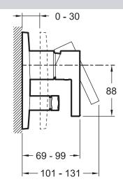
Спецификация продукта: Встраиваемый смеситель с переключателем на 2 выхода. E98723. Коллекция: STILLNESS. BEC: 2.1 кг. MATEPИAЛ: N/A. ТИП УСТАНОВКИ: Встраиваемые. TYPE D'ACCESSOIRE: 0. AVEC OU SANS ROBINETTERIE: 0. MITIGEUR: 0. TYPOLOGIE DE ROBINETTERIE DE DOUCHE: 0. FORME DE LA DOUCHE DE T©TE: 0. INVERSEUR: Встраиваемый. TYPE DE FLEXIBLE: 0. Автоматический переключатель с функцией блокировки.
